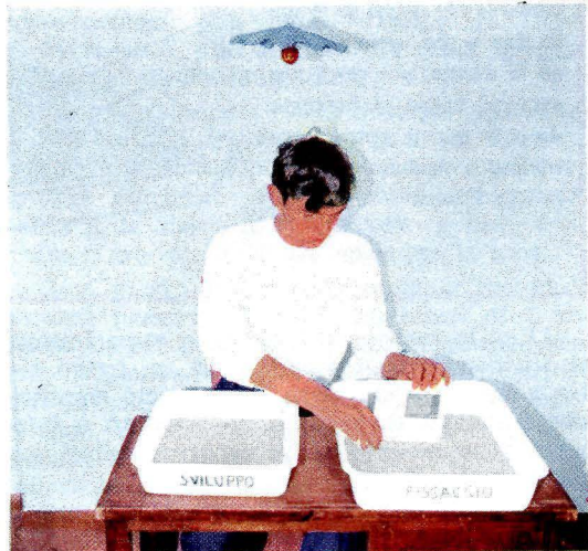
Fig. 23 - Vi ricordiamo che, una volta tolta la copia positiva dal bagno di fissaggio, prima di appenderla ad asciugare, occorrerà lavarla in acqua corrente per almeno cinque-sei minuti, onde togliere dalla sua superficie i residui dei sali dei vari bagni.
