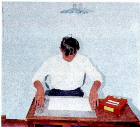
Fig. 2 - La carta grafoflex verrà tolta dal pacco esclusivamente alla luce rossa; solamente dopo che questa sia già stata posta a contatto con la copia da riprodurre, si potrà accendere la luce bianca. Ricordatevi sempre di chiudere bene la scatola contenente la carta sensibile grafoflex perché la luce bianca la impressionerebbe e la renderebbe inutilizzabile.
