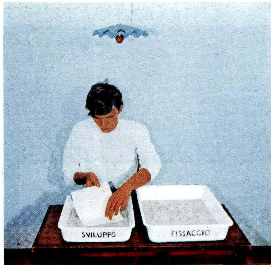
Fig. 16 - Il positivo, una volta impressionato per il tempo necessario, verrà tolto da sotto il vetro e immerso nel bagno di sviluppo e qui lasciato fino a che non appariranno ben nitide le scritte. Durante questa operazione dovrete impiegare solamente la luce rossa.
