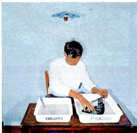
Fig. 7 - Tolta la negativa dal bagno di sviluppo, la immergerete subito nel secondo bagno, quello di fissaggio, che avrete già pronto in un'altra bacinella. E' importante ricordare che i due liquidi, una volta utilizzati, andranno sempre riposti in due bottiglie separate e ben distinte, perché, se qualche goccia di fissaggio cadesse nel liquido di sviluppo, questo si rovinerebbe irrimediabilmente. La negativa, nel bagno di fissaggio dovrà rimanere per circa 20-30 minuti.
