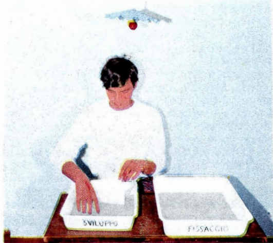
Fig. 4 - Dopo aver esposto la carta alla lampadina bianca, sempre alla luce della lampadina rossa, potrete togliere da sotto al vetro la carta graforefless ed immergerla nel bagno di sviluppo che avrete già in precedenza preparato secondo le istruzioni dettate nell'articolo. Precisiamo che il foglio impressionato, se tenuto al buio od esposto alla sola luce rossa, potrà anche essere sviluppato dopo diversi giorni, senza che nulla risulti modificato.
